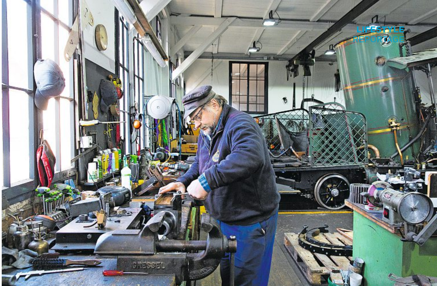
Eisen, Schmierfett und viel Nostalgie: Martin Horath zerlegt und reinigt die Lok 7, damit sie auch mit 148 noch Gäste auf die Rigi bringen kann.
