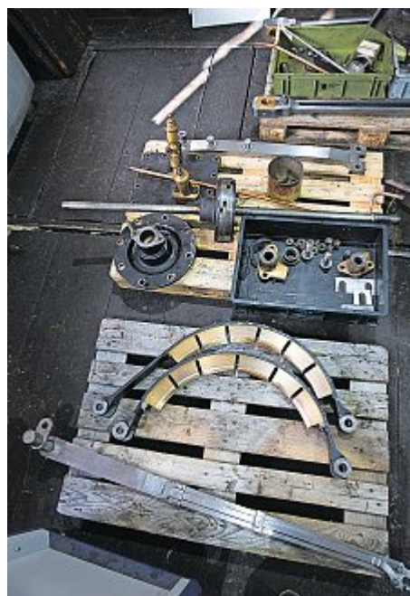
Bausatz für Kenner: Teile der Dampfmaschine (oben), geteiltes Bremsband.
